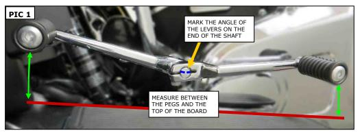
REMOVE THE PINCH SCREW, THEN SLIDE THE LEVER OFF THE SHAFT
